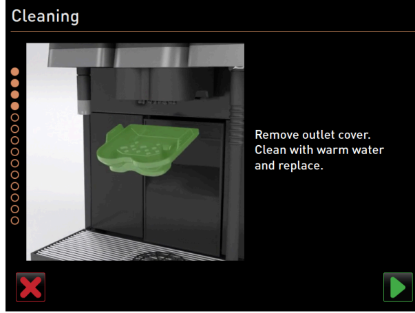
Şekil: İçecek çıkışı kapağını çıkartma
