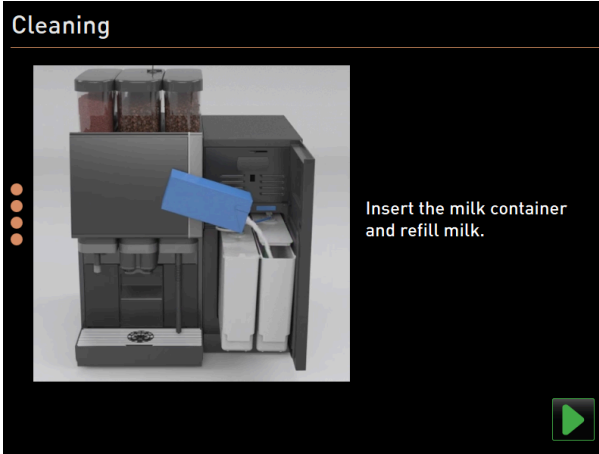
Şekil: Süt kabının yerleştirilmesi
