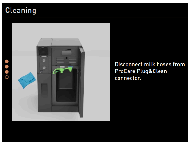
图：移除 Plug&Clean 接口上的牛奶软管
