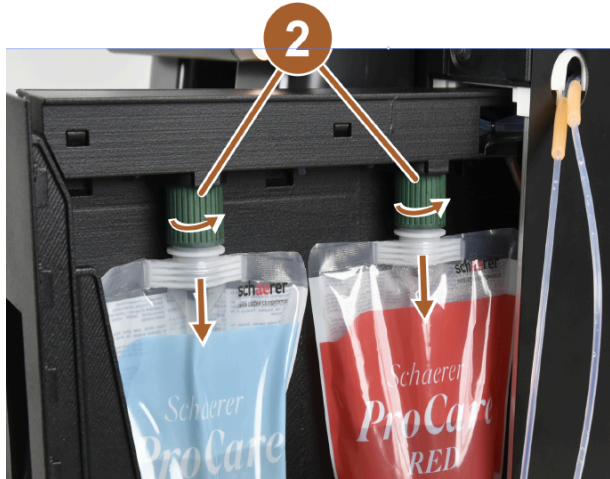
صورة: إزالة أكياس التنظيف
