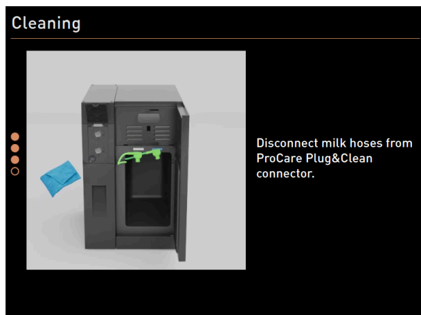
Fig.: Retirada de los tubos flexibles de leche de las conexiones Plug&Clean
