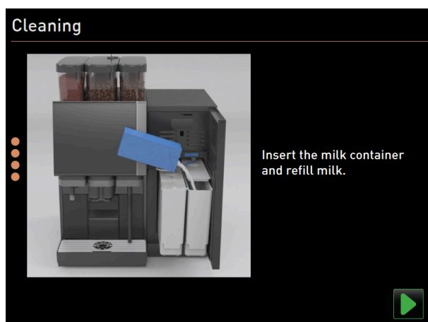
Fig.: Colocación del depósito de leche
