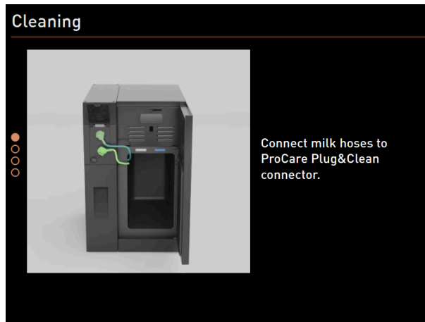
Fig.: Conexión de los tubos flexibles de leche a las conexiones Plug&Clean
