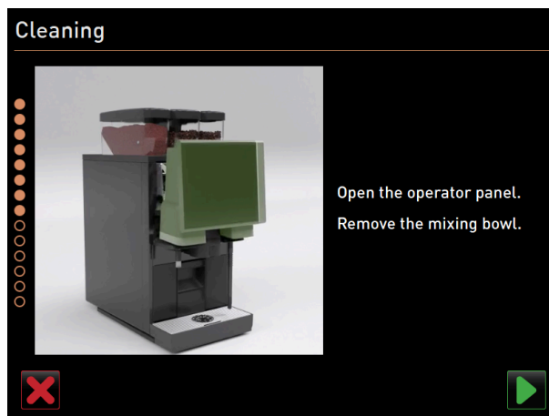
Figura: Sollevamento del pannello di comando
