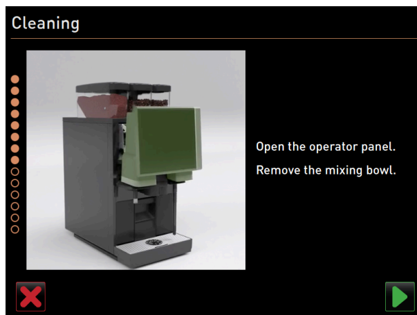
Afbeelding: Bedieningspaneel optillen
