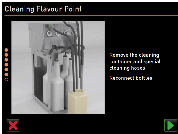
Abb.: Reinigungsbehälter wieder entfernen
