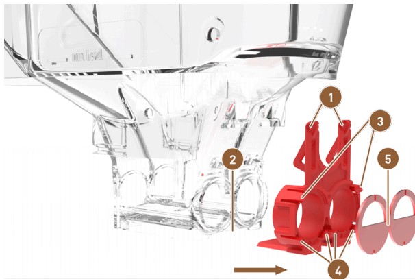
Fig.: Depósito de polvo Twin: Retirar elementos dosificadores
