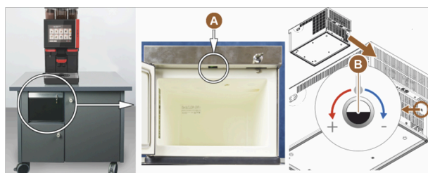
Fig.: Conectar y ajustar la unidad refrigeradora bajo mostrador
