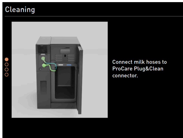
Fig.: Conectar los tubos flexibles de leche a la conexión Plug&Clean
