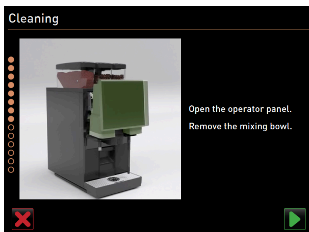
Fig.: Levantar el panel de control
