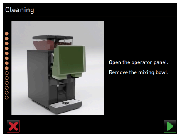
Fig.: Levantar el panel de control
