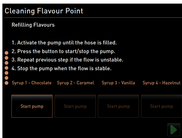
Fig.: Llenado de los tubos flexibles de jarabe
