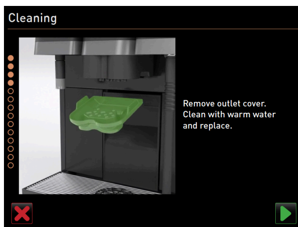
Fig.: Retirar la cubierta de la salida de bebida
