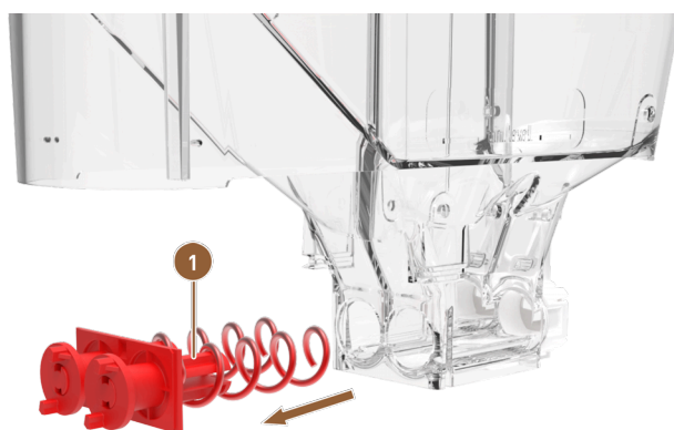
Fig.: Depósito de polvo Twin: Retirar unidad transportadora
