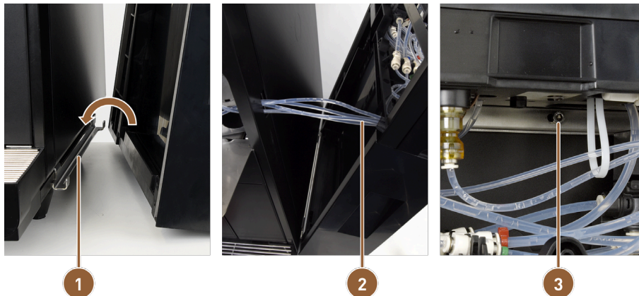
Fig.: Fijar la unidad ProCare a la máquina
