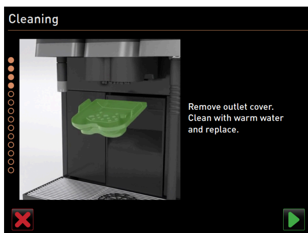
Afbeelding: Afdekking uitloop verwijderen
