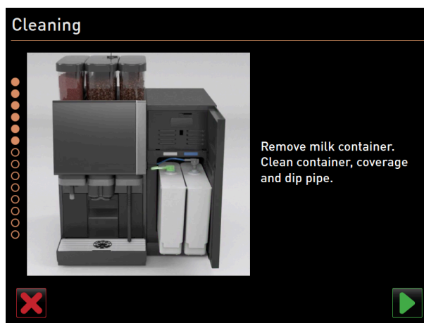
Afbeelding: Melkcontainer reinigen (optie)
