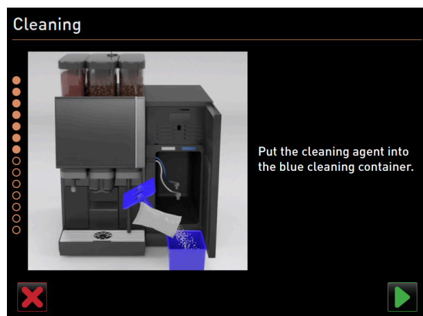
Afbeelding: Reinigingsmiddel in de reinigingscontainer gieten Benodigd reinigingsmiddel: Milkpure powder
