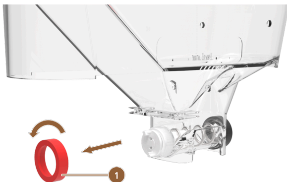
Afbeelding: Standaard poedercontainer: Wartelmoer aan transportzijde verwijderen
