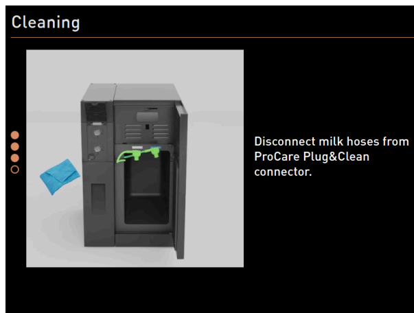
Afbeelding: Melkslangen van Plug&Clean -aansluitingen verwijderen
