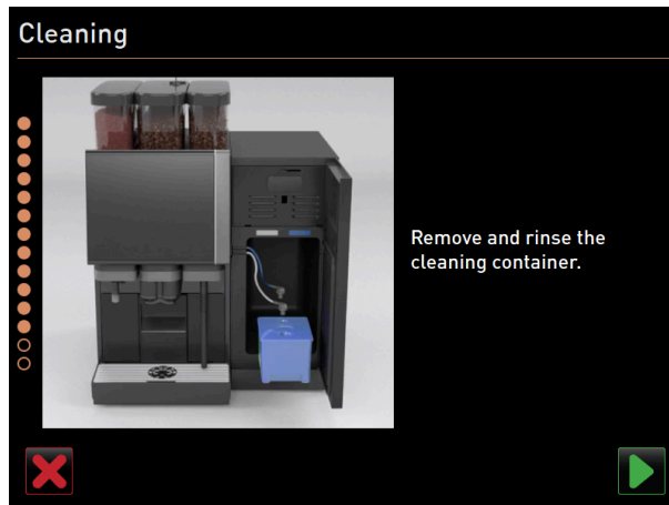
Afbeelding: Reinigingscontainer verwijderen
