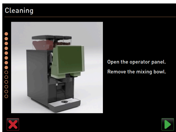
Afbeelding: Bedieningspaneel optillen
