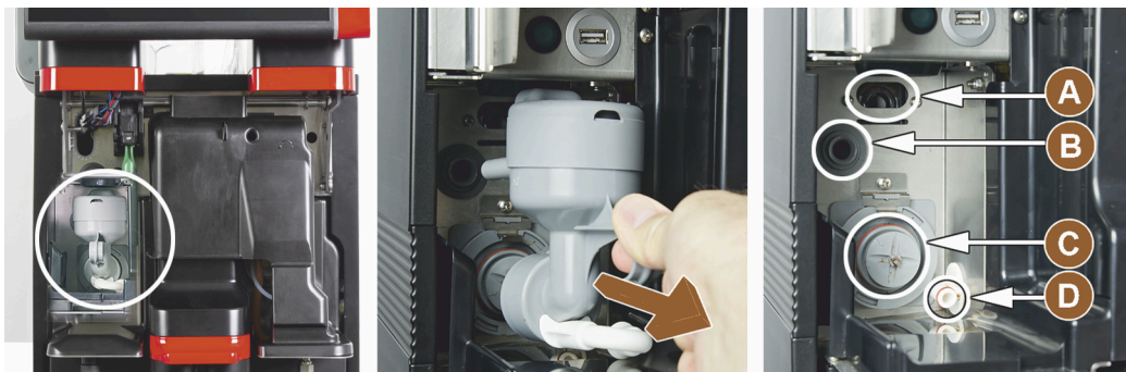
Afbeelding: Bedieningselementen op mixerbeker voor poeder- of topping-systeem (optie)
