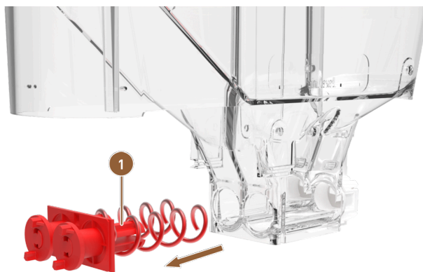
Afbeelding: Twin-poedercontainer: Transportunit verwijderen
