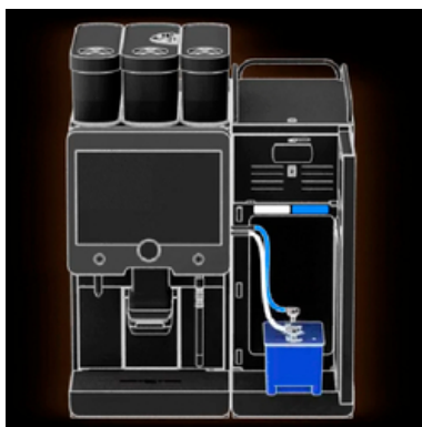
Afbeelding: Reinigingscontainer in koelunit plaatsen
