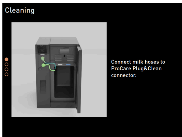
图：将牛奶软管连接到 Plug&Clean 接口
