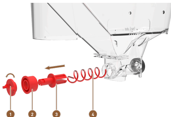
图：标准粉末槽：拆解输送单元
