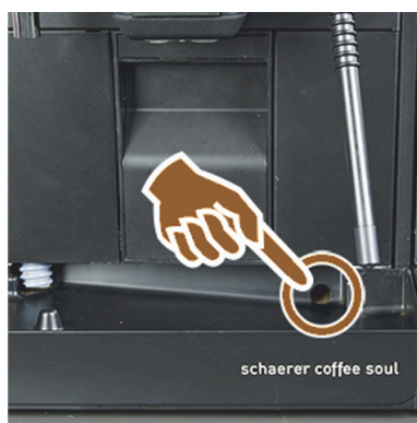
圖: 檢查廢水出口
